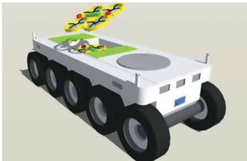
Рис. 1. Универсальная роботизированная платформа — носитель БЛА и МНР
